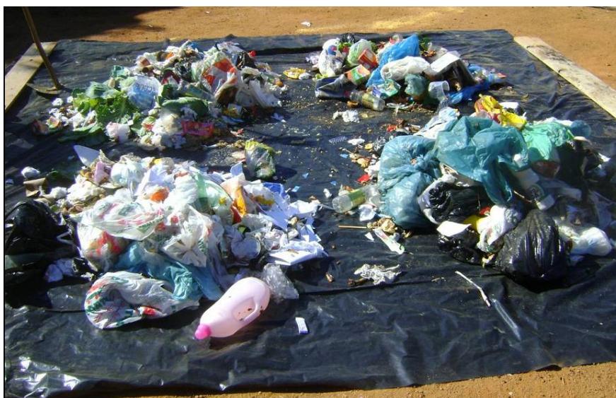
Figura 01 – Realização da técnica de quarteamento para determinação da composição gravimétrica.
